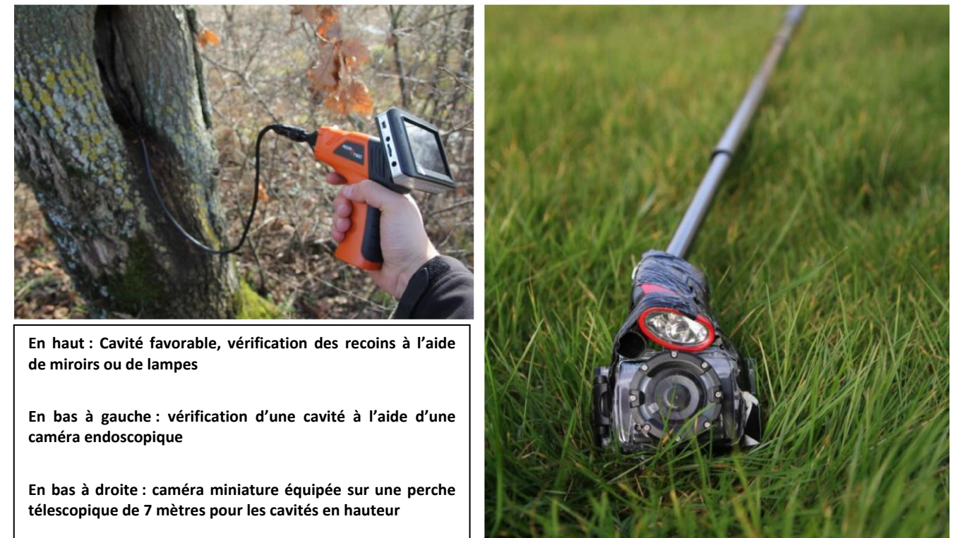
Figure 28: Techniques utilisées pour la vérification de cavités
